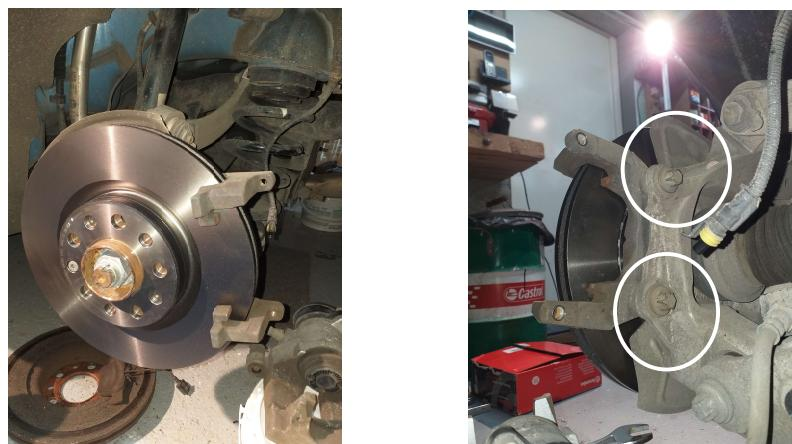
Mettre en place les plaquettes de freins neuves, la plaquette avec le témoin d' usure vers l'intérieur
