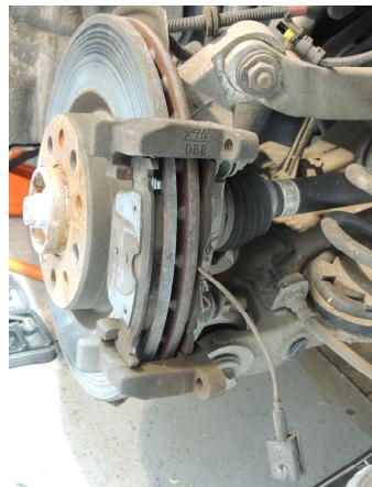
Dévisser les vis (Clé Torx Femelle STX 18) et déposer la chape de l'étrier de frein
