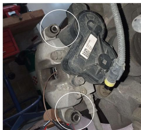
Remettre les bouchons de protection des vis de fixation de l'étrier
