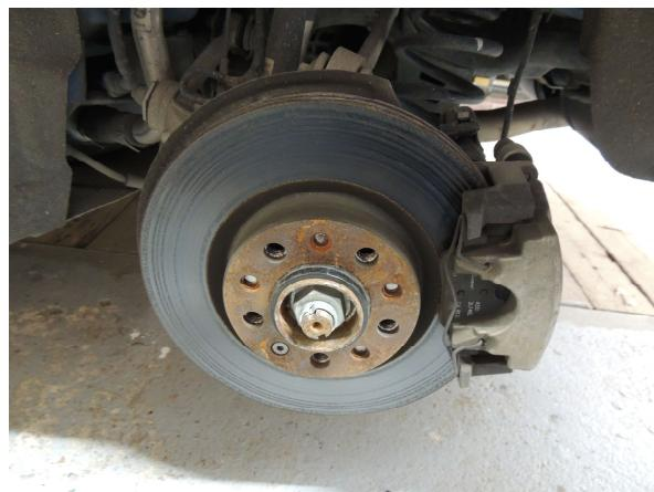
Déconnecter le capteur d'usure des plaquettes de freins.
