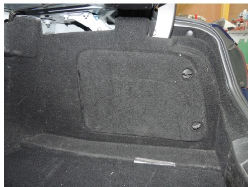
Remettre en place le tirant à corde d'ouverture du capot du coffre à bagages dans son logement et fermer le bouchon.
