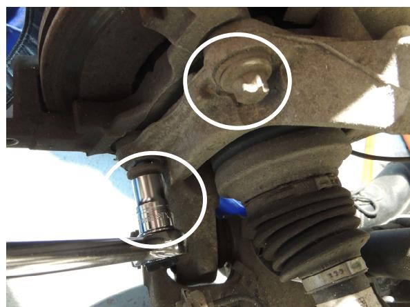
Dévissez la vis (Clé male 5mm) et déposez le disque de freins
