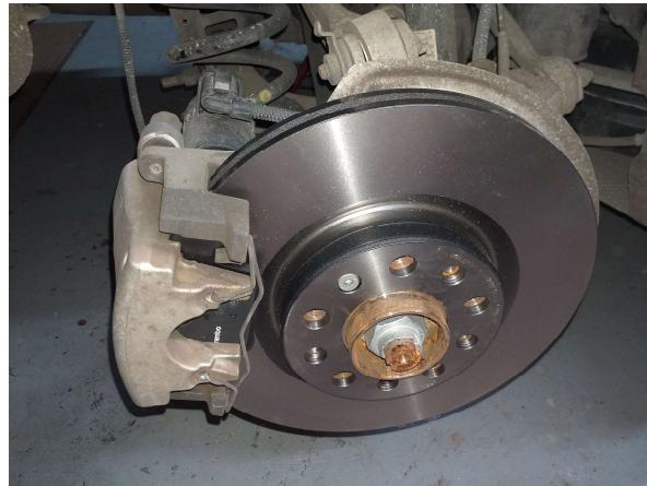
Rebranchez la connexion du témoin d'usure des plaquettes de freins
