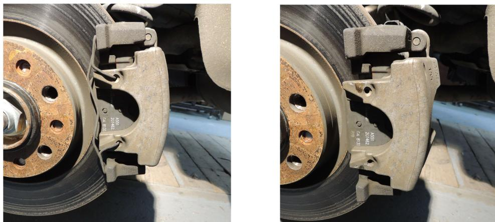
Démontez les capuchons de protection des vis de fixation de l'étrier.
